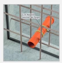
MASTERSTOP SK wird innerhalb der Bewehrung mit 6 cm Betondeckung um das Rohr geklebt.
