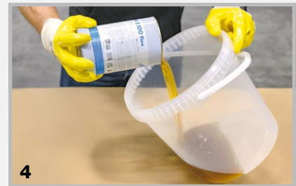
4 Das durchmischte Material in ein sauberes, staubfreies Gefäß für die maschinelle oder manuelle Weiterverarbeitung umfüllen.
