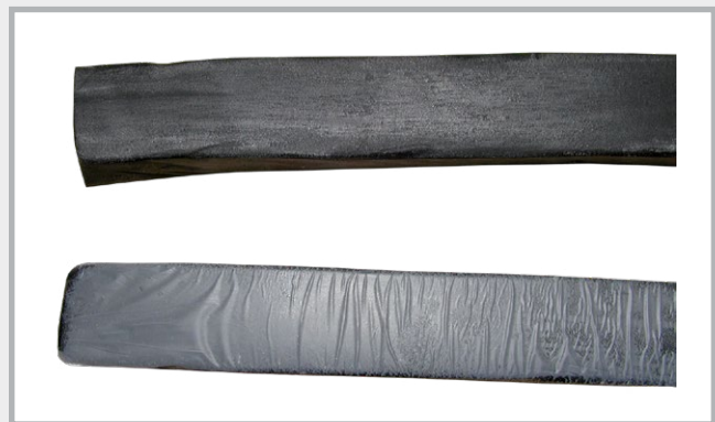
Vergleich Quellband mit und ohne Schutzhülle
