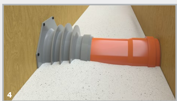
4 Betonage und sorgfältige Verdichtung
